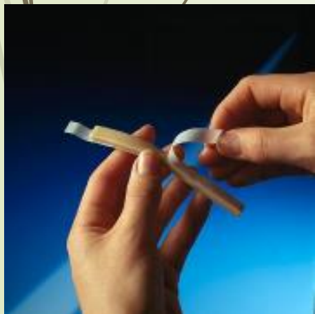
Рис. 1. Применение пасты герметик в полоске для выравнивания
